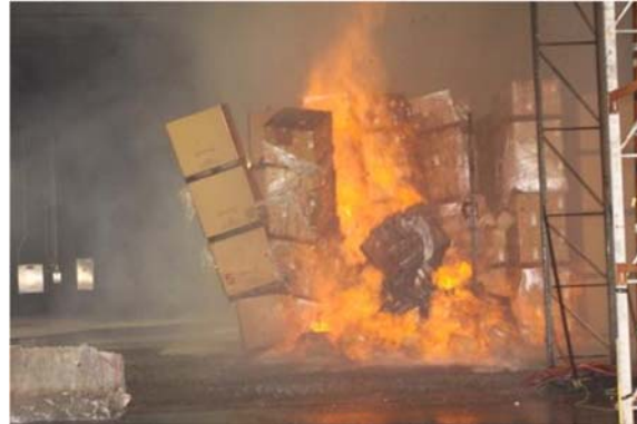
Array Collapse (5 min 14 s)
